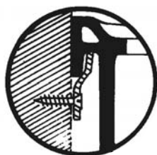
Detalj bilde av opphengsjern
