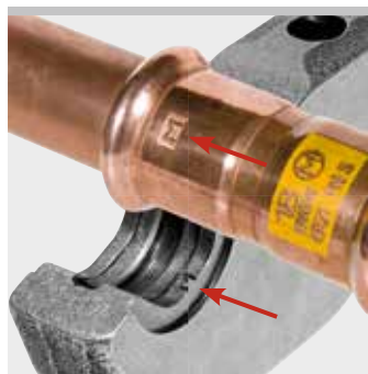
Eksempel REMS presstang M: Aftryk "M" på en pressfitting til sporbar- hedsdokumentation til EN 1775:2007
