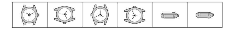
CROWN RIGHTCROWN DOWNCROWN LEFTCROWN UPDIAL UPDIAL DOWNCRCDCLCUDUDD
